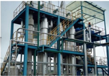
英德市茂鑫生物能科技实业有限公司 物化废水 2T/H三效蒸发器 1套
