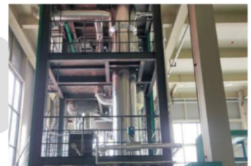
梅州侨韵环保科技有限公司 氯化铵蒸发结晶 6T/H MVR 蒸发器 1套、3.5T/H双效蒸发器 1套
