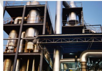
肇庆焕发生物科技有限公司 糖浆浓缩项目 10T/H MVR蒸发系统
